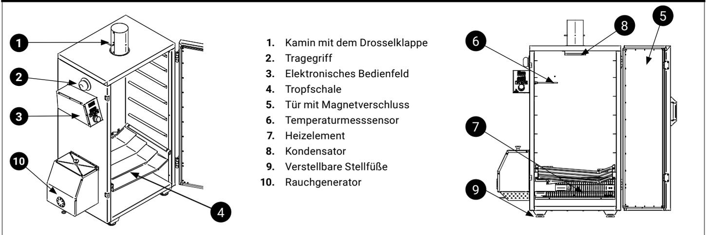
Beschreibung des Funktionsweise des Räucherofens mit Rauchgenerator: Die Räucherofen arbeitet nach dem Prinzip der kontrollierten Raucherzeugung und der Aufrechterhaltung der richtigen Temperatur, die für den Räucherprozess von entscheidender Bedeutung sind. So arbeiten die einzelnen Komponenten des Geräts zusammen:
